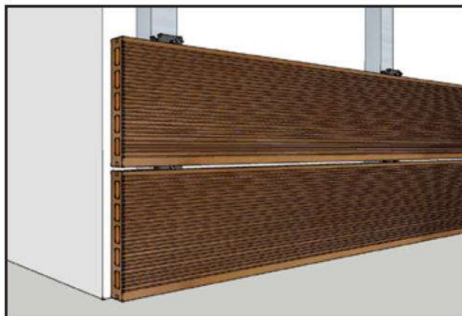
Montaggio del rivestimento in doghe di WPC
