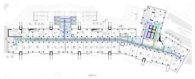
Le dorsali impiantistiche correranno nel connettivo controsoffittato ad altezza di ml. 2,40, e, laddove necessario per l'attraversamento di locali, saranno realizzate apposite velette di cartongesso.
