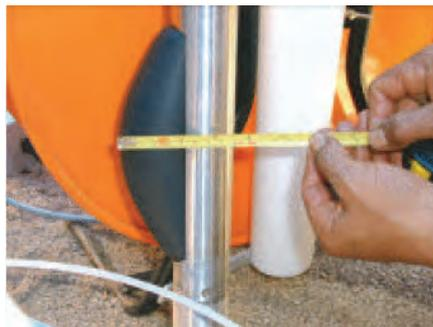
Fig. 2: sistema di ancoraggio alle pareti del foro
